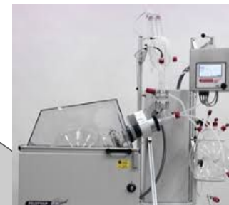
GENSER 20 L Rotaevaporator
