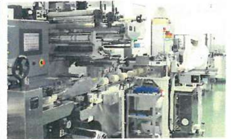
製品をフィルムでオーバーラップするシュリンク包装ライン A shrink wrapping line where products are overwrapped with a film
