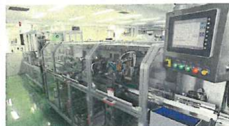
錠剤をPTP包装する最新鋭の充填機 A cutting-edge filling machine for PTP packing of tablets
