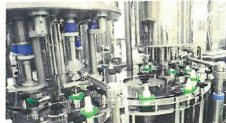
容器のエア洗浄から重量チェックまで行う最新鋭のローション充填ライン A cutting-edge lotion liquid filling line handles various processes from the air washing of containers to weight verification
