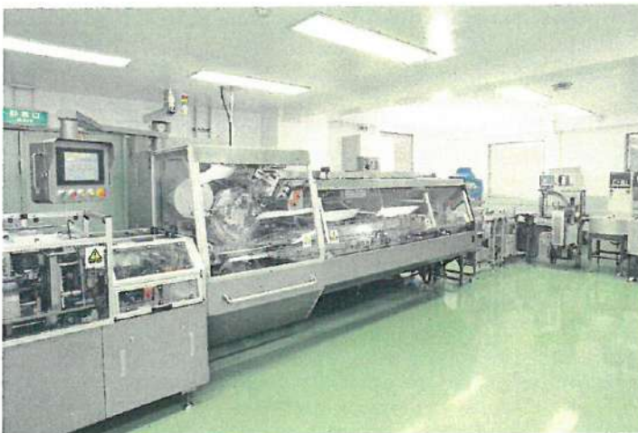
箱作りから製品の投入・封緘および印字・計量まで自動化されたカートニングマシンライン An automated cartoning machine line that handles the preparation of packages and packing of products, sealing, printing and weighing
